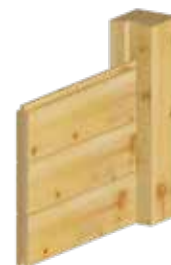
L'EMPILEMENT ENTRE POTEAUX RAINURÉS
